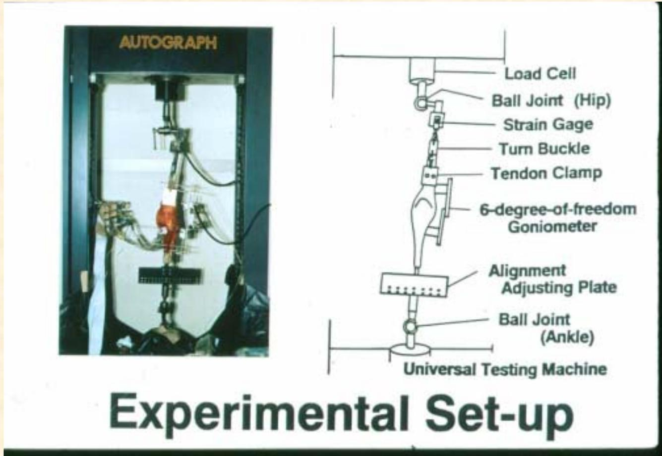
万能材料試験機を用いた負荷装置
